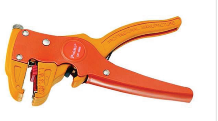
Зачистка изоляции 808-080(CP-080E) для шлейфа, провода 0.2-4 мм2
