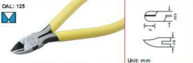
Бокорезы 1PK-5101CE 125мм, крепление внахлест, грани губок под углом 20°, для провода диаметром до 2мм
