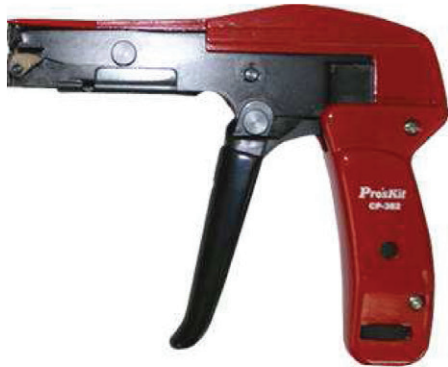
CP-382 устройство для затягивания хомутов на кабель
